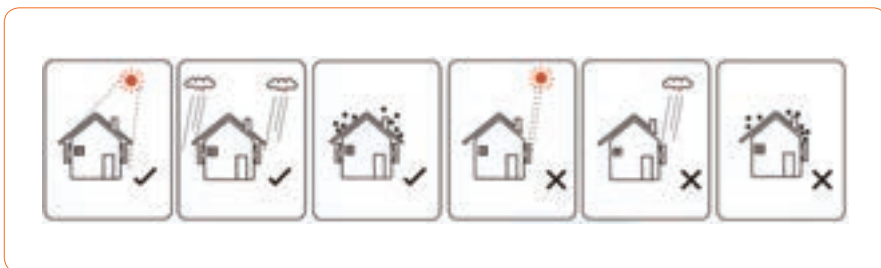
Rysunek 4-1 Rekomendowane miejsce instalacji
